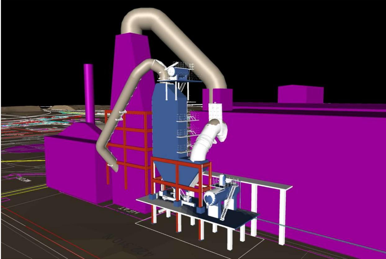
**FIGURE 7.6 3D MODEL AQC BOILER**
