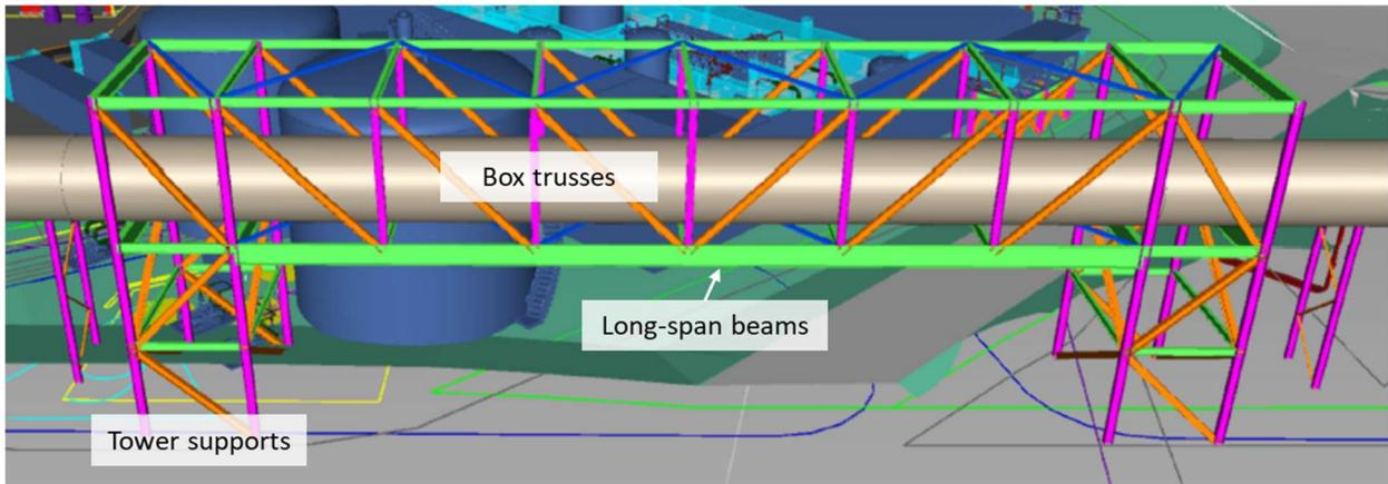
**FIGURE 3.5 TYPICAL TRUSSED ROAD CROSSING**
