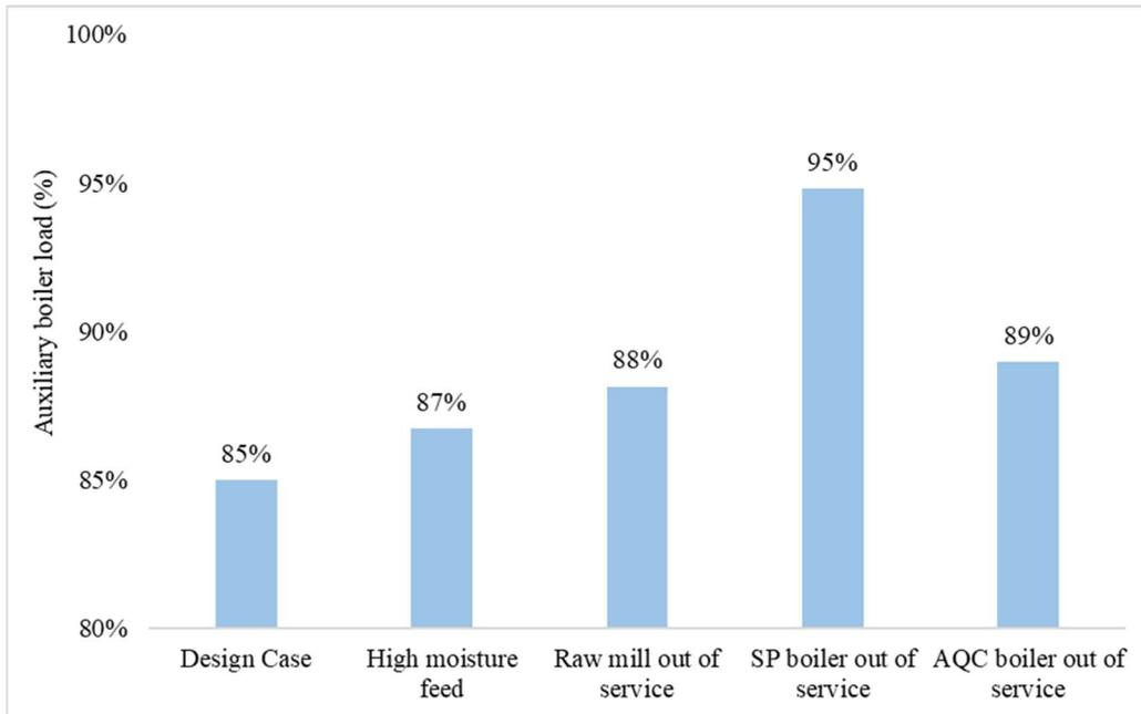
**FIGURE 7.8 AUXILIARY BOILER LOAD AT DIFFERENT WASTE HEAT RECOVERY SYSTEM OPERATING CONDITIONS**
