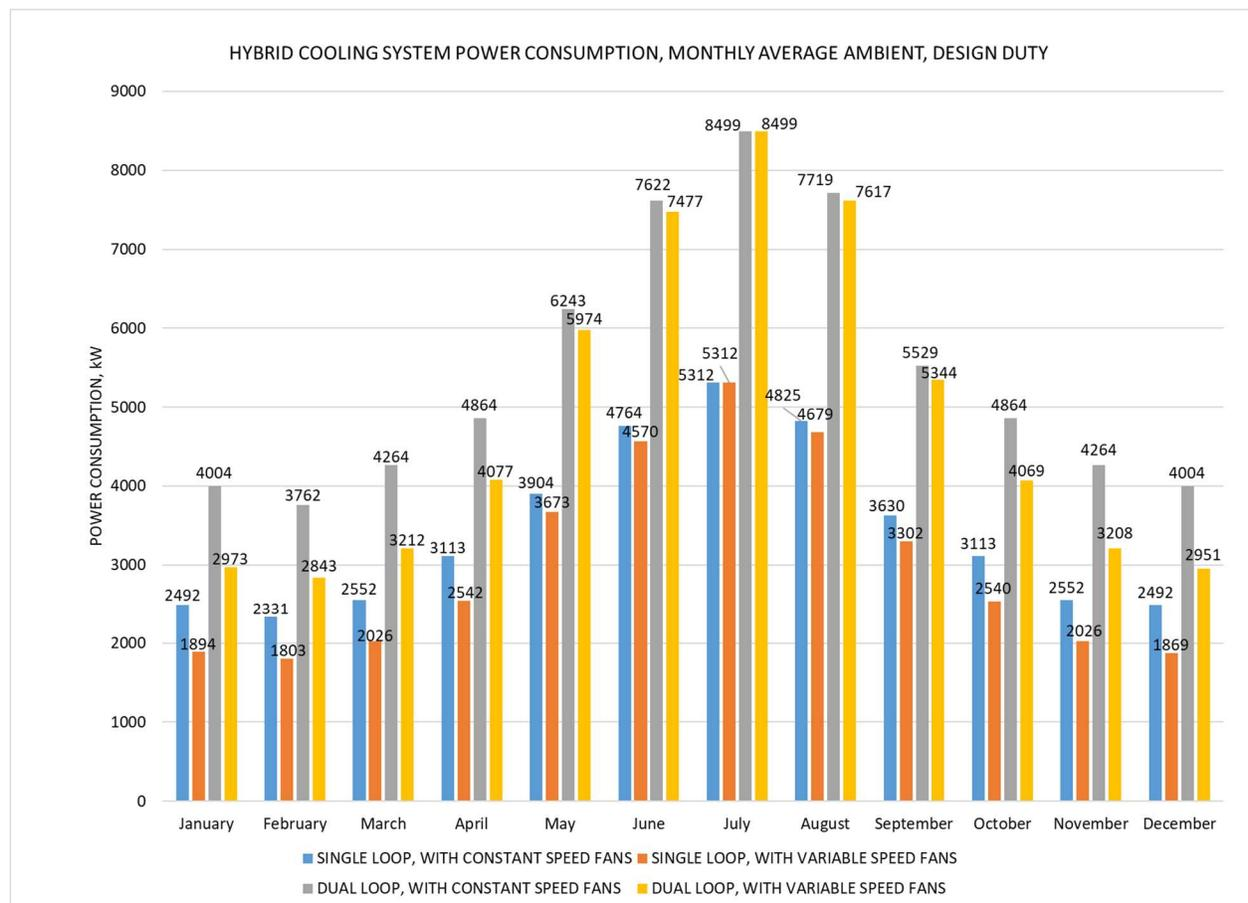
**FIGURE 5.4 HYBRID COOLING SYSTEM POWER CONSUMPTION**
