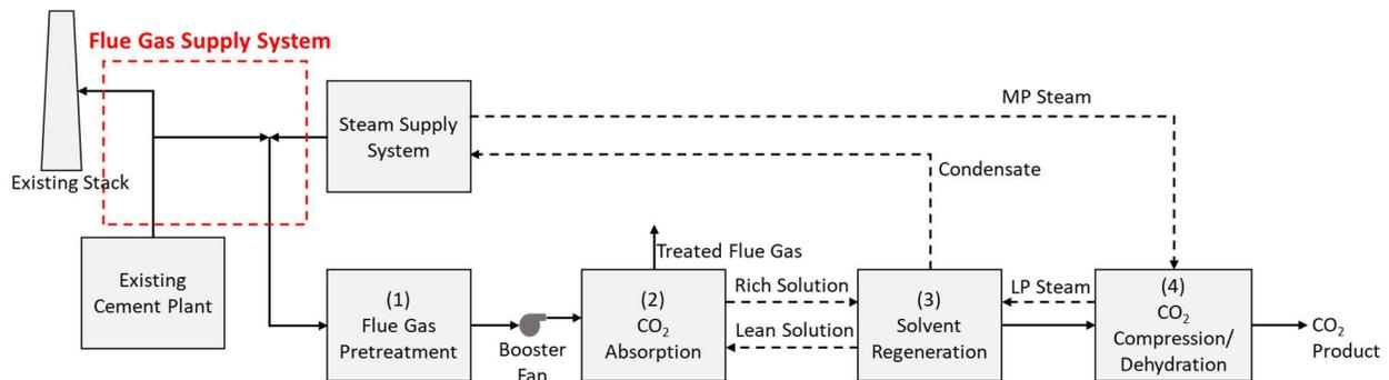
FIGURE 3.1 FLUE GAS SUPPLY SYSTEM
