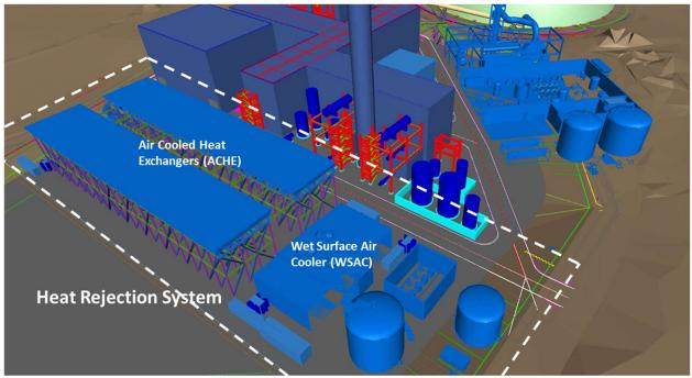
FIGURE 5.1 3D GRAPHICS FOR HEAT REJECTION SYSTEM
