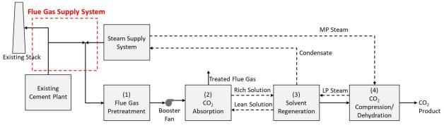
FIGURE 3.1 FLUE GAS SUPPLY SYSTEM
