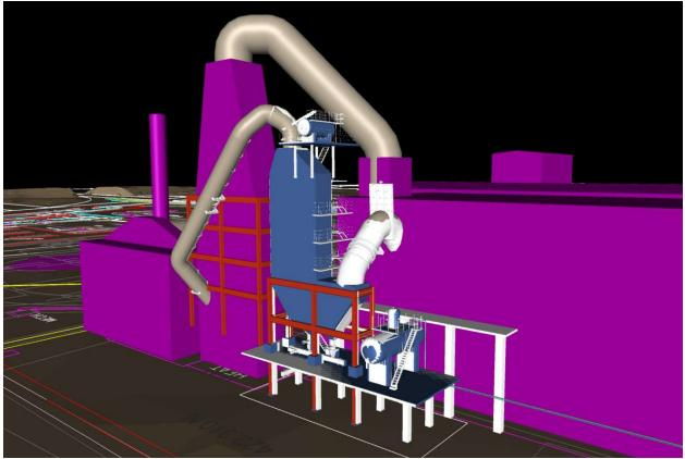
FIGURE 7.6 3D MODEL AQC BOILER
