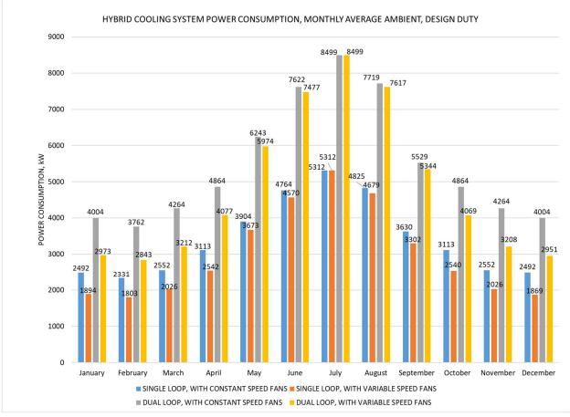
FIGURE 5.4 HYBRID COOLING SYSTEM POWER CONSUMPTION
